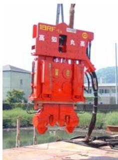
今までのパイロ工法での欠点を克服しました新導入機種のご紹介。オランダ製の低振動低騒音都市型パイロフォンサーICE18-RF。
