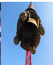
トリコン拡大 中掘工法
