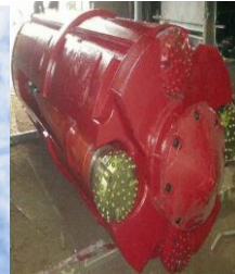
マルチ拡大 ダウンザ工法
