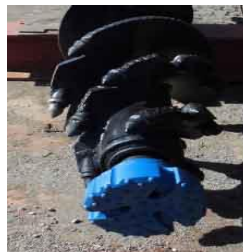
コニカル拡大 ダウンザホール圧入工法
