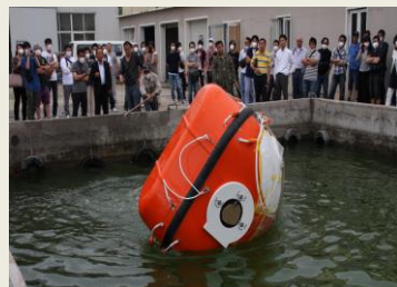
津波避難シェルター 落下・転倒・起き上がり実験
