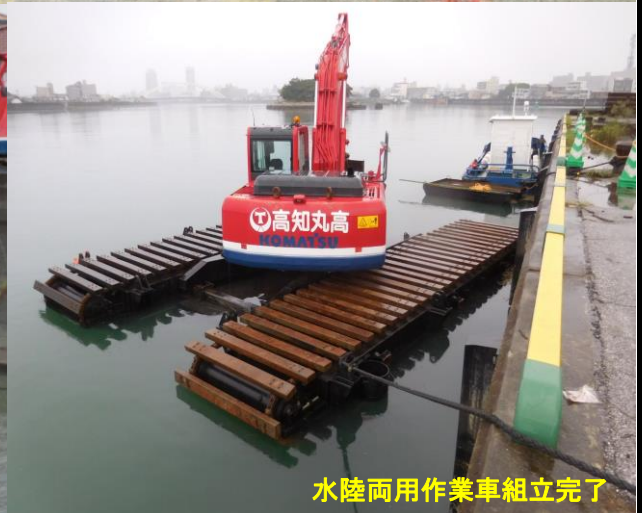
組立式自航艇 組立は1時間で完了
