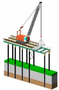
5.I型鋼格子床板設置
