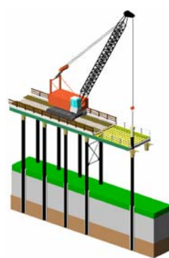
4.鋼管杭挿入 支持力 (モンケン)確認
