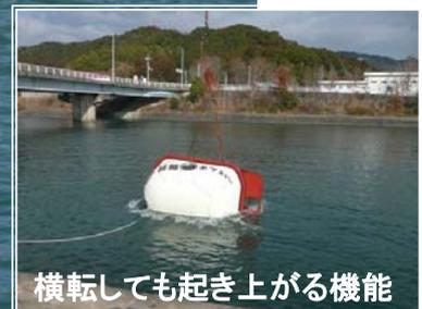
落下実験、横転実験、火災実験、載荷実験、衝撃実験の各種実験を行い、損傷や構造的問題は無く、火災実験では20分間燃焼させ、室内30℃・室外160度という計測値となりました。
