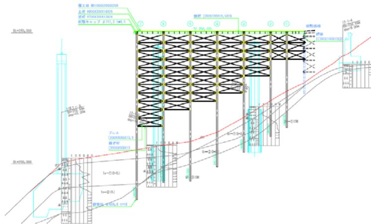
右岸 SqCピア工法架設構台
