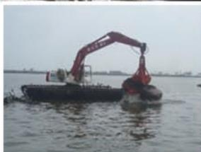
災害、地震により発生する液状化。それに伴う地盤沈下、浸水に備え、現場へ即、救助・瓦礫撤去・道路復旧に活躍できる特殊水陸作業車
