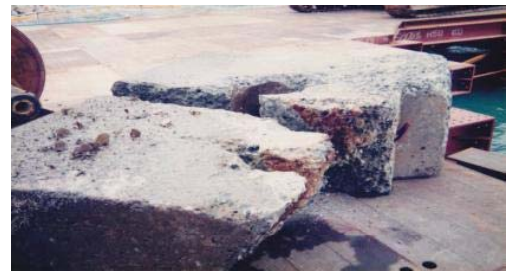
ロックジェットの威力による 花崗岩に穴が開く(ノズル径10mm)
