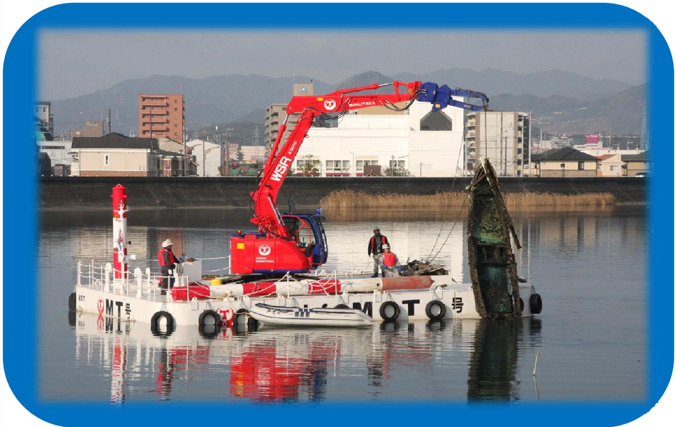
災害時、早い段階で人命救助や物資の輸送を円滑に行え、短時間で組立できる。又河川の工事において、水深が浅く橋脚も低い通常の作業船では入れない現場、ダム湖、河川での浚渫工事、土砂流によるダム水の排出ポンプ付台船などにも活躍。
