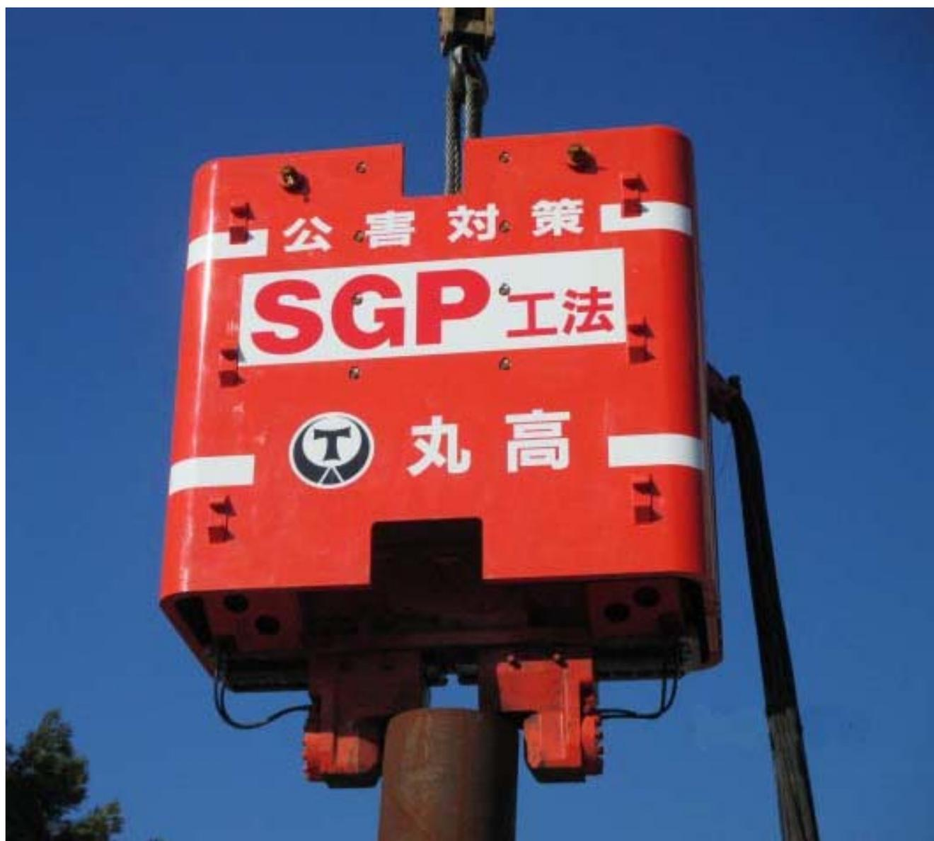
住宅密集地での施工にも 騒音 79dB・振動 46dBと基準をクリアし施工
