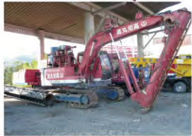
小型杭打機 6台
