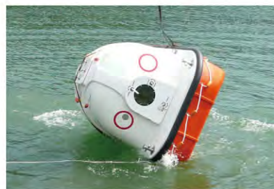
＜転倒起き上がり実験＞ 本体を転覆させても自然に起きあがる
