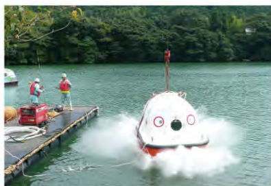
＜落下実験＞ 水面上3mからの落下に耐える
