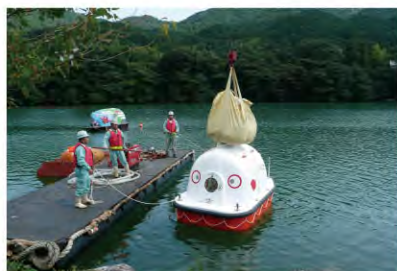
＜衝撃実験＞ 本体の1m上方より1t土嚢の落下に耐える
