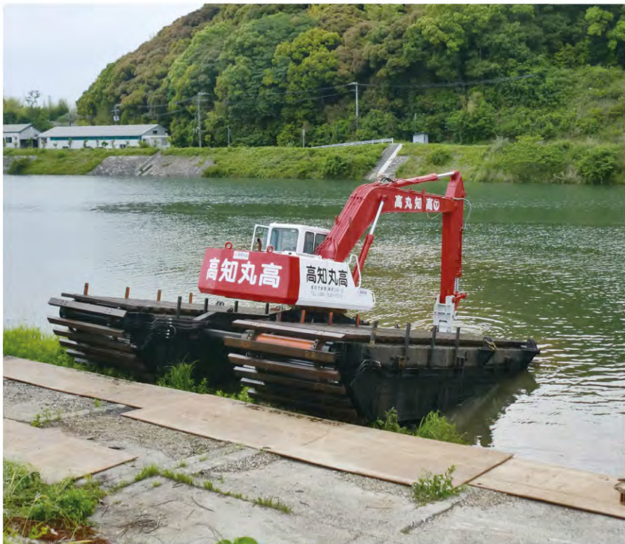
用 途／コンクリート・破碎機・鉄骨クラッシャー・掘削深藻バケット 吊荷重／小型1.5t・大型3.0t
