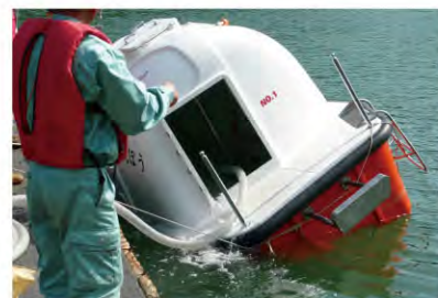
＜浸水実験＞ 艇内の室内高1/2まで浸水しても沈没しない
