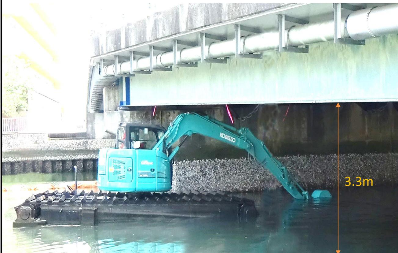
水中ブルドーザー、橋梁下の低空間は2.0mであれば浚渫可能。
