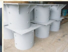
Sqc橋 杭頭キャップ Pile cap of Sqc bridge
