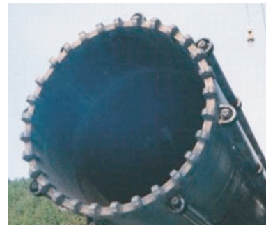
鋼管杭(矢板) 先行ジェット・エア配管例 Steel pipe piles (sheet piles) preceding jet/air tube
