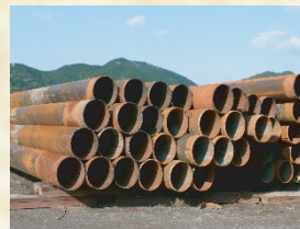
鋼管杭 Steel pipe pile
