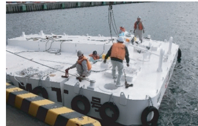
自航台船組立 (1時間) Barge assembly time 1hr
