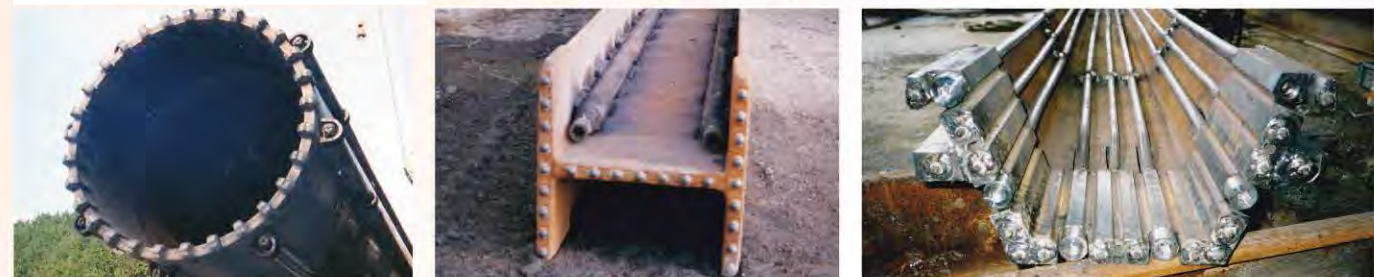
鋼管杭(矢板)先行ジェット・エア配管例 H型鋼 先行ジェット・エア配管例 鋼矢板 先行ジェット・エア配管例
