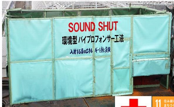
パイロフォンサーユニット用防音装置
