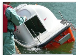
浸水実験確認
