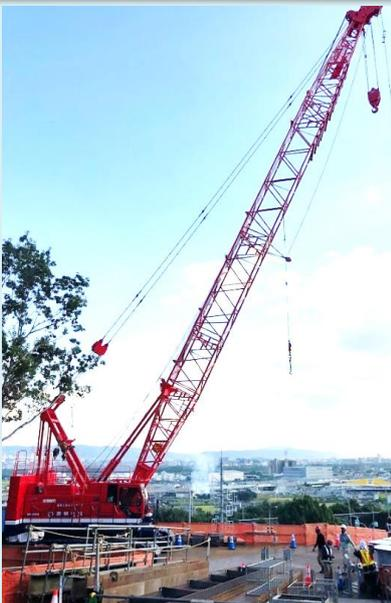
「NETIS」に登録された省エネシステム「Gモード」を搭載。停車時のエンジンストップを促す「オートアイドルストップ」など三つの省エネ機能を持ち、従来機より燃料消費量を最大25%カットできる「環境に優しいクレーン」となっています。最大定格総荷重は100t×3・8m。ブーム延長は13・8～62・8mの範囲で設定できます。キヤタ最大張出4・9mの最新型100tクローラクレーンを3台保有。リニア中央新幹線工事を中心に稼働中。
