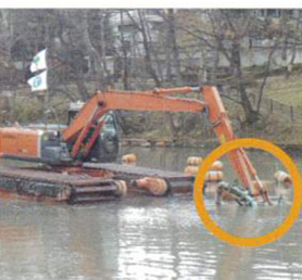
水深0～10m 泥状掘削機取付例
